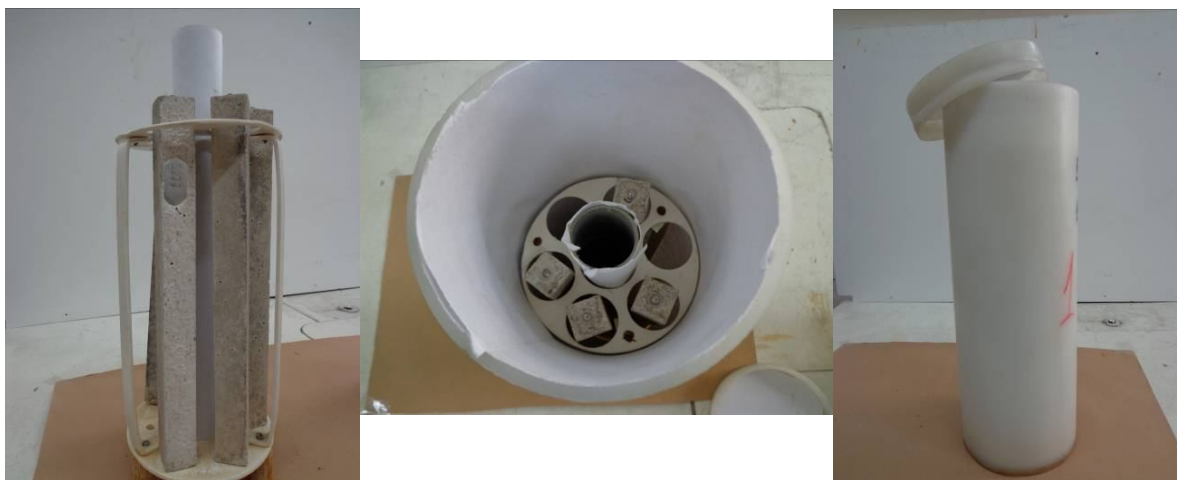
Figura 3. Equipo para ensayo ASTM C227
