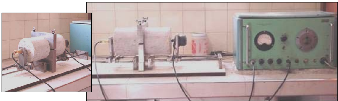
Figura 3.3.3.3. Equipo para la determinación del módulo de elasticidad dinámico.
