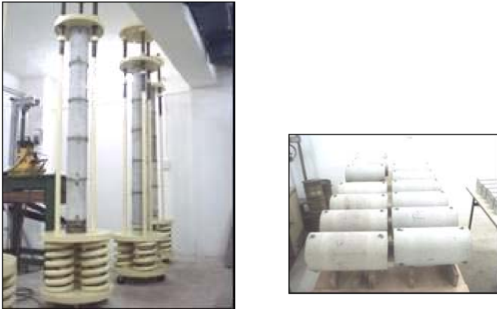
Figura 3.3.3.13. Pórticos con resortes y detalle de las probetas con los pernos de acero inoxidable, en la foto se muestran los ensayos para el estudio del inciso 4.4.
