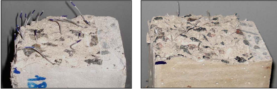
Figura 3.3.2.1. Superficies fracturadas de vigas entalladas ensayadas a flexión. Izquierda: HRFacero. Derecha: HRFsintética.
