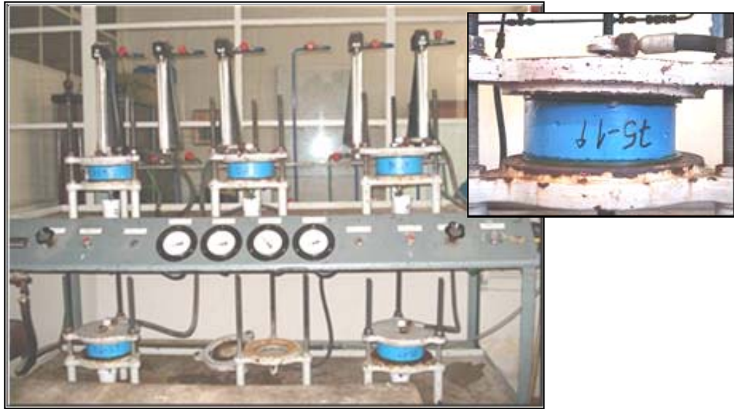
Figura 3.3.3.5. Equipo utilizado para los ensayos de permeabilidad y penetración de agua a presión. La foto corresponde al ensayo de permeabilidad.
