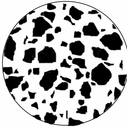
Figura 5.6.2. Distribución de agregados sobre un corte de 20 mm de espesor.
