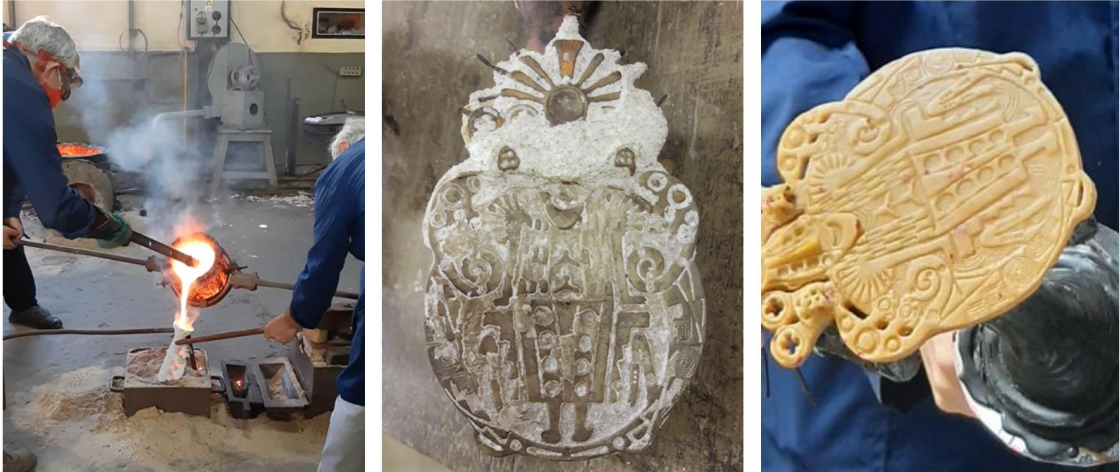
Fundidores del LEMIT realizando la réplica de la pieza.
